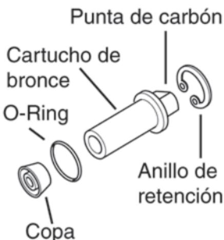
3. Aplique lubricante a los O-rings externos del cartucho nuevo e instale el nuevo cartucho en el soporte de muñón; luego, vuelva a instalar los anillos de retención para sujetar el nuevo conjunto.
